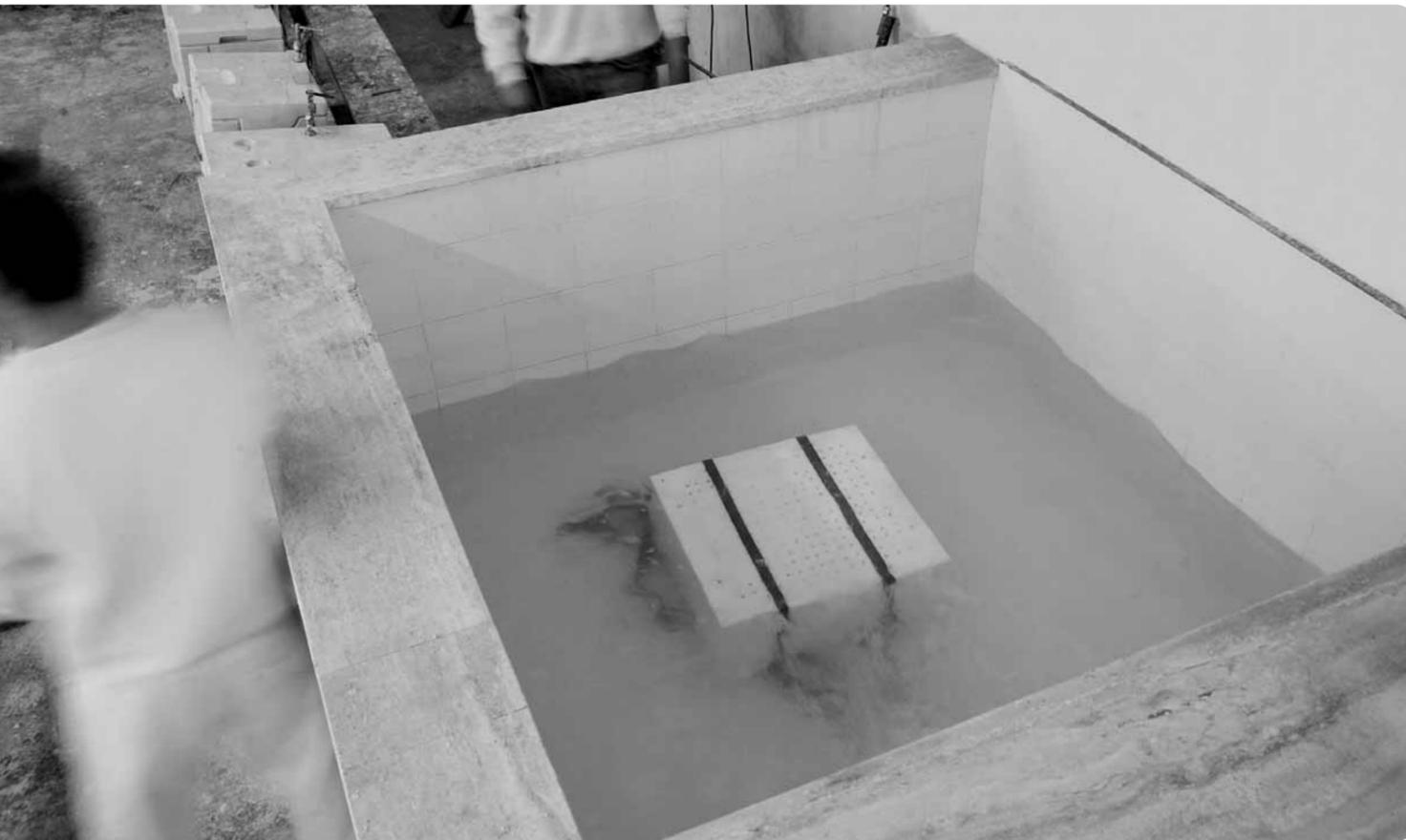
Nella fase finale della lavorazione la stampa colata è pronta per la sformatura dalla matrice. Viene immersa in una vasca d'acqua ad una temperatura di 45° e lasciata in raffreddamento e rassodamento. Questo per controllare le eventuali deformazioni.
