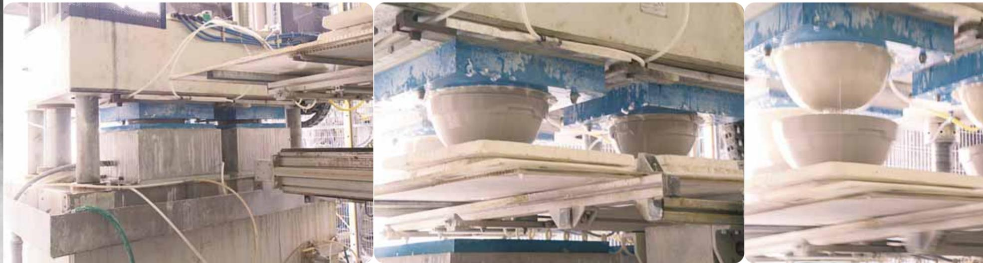
Il collaudo avviene direttamente presso il cliente, consiste nell'istallare lo stampo micro poroso sul banco di colaggio e aiutare con degli interventi mirati per avere una lavorazione ottimale.
